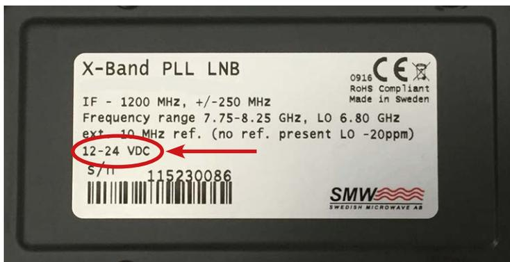
**Fig. 1** LNB Input DC Voltage
